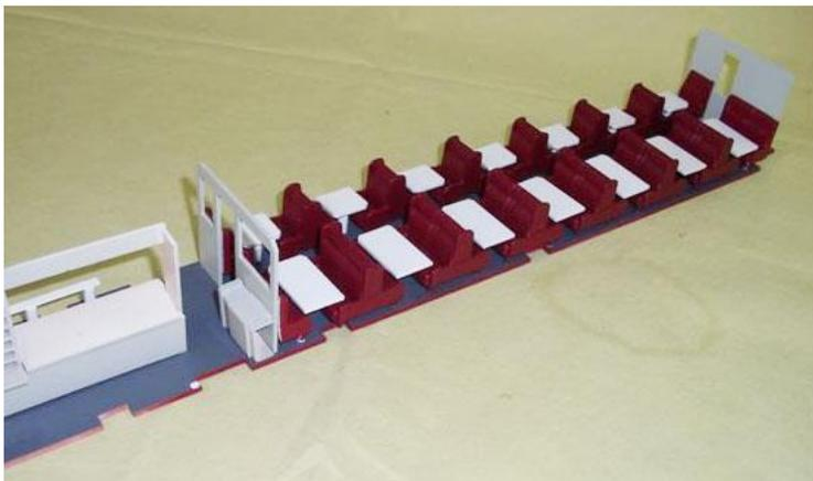
Die Interieurplatte wird auf die Bodenplatte geschraubt mit 1,8 mm Schrauben. Mit Klebeband werden die Küchefenster abgedeckt.
